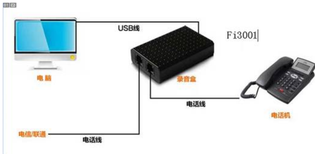
Fi3001 USB录音盒安装 接线示意图
